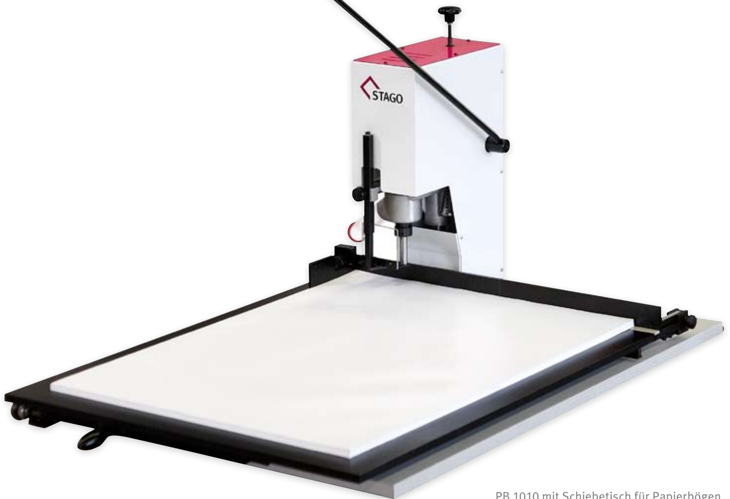
PB 1010 mit Schiebetisch für Papierbögen bis zum Format 50 x 70cm
